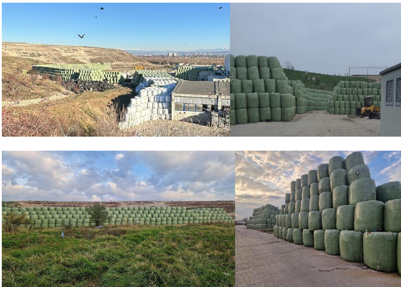
Foto 3: Baloti de RDF rezultati din tratarea mecanica – pregatiti pentru incinerare
